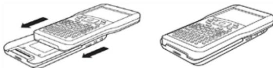
3. Pour une connexion optimale, une bonne mise en place est nécessaire. Lorsqu'elle est correctement connectée, l'unité semble reposer sur le dessus de la station.
