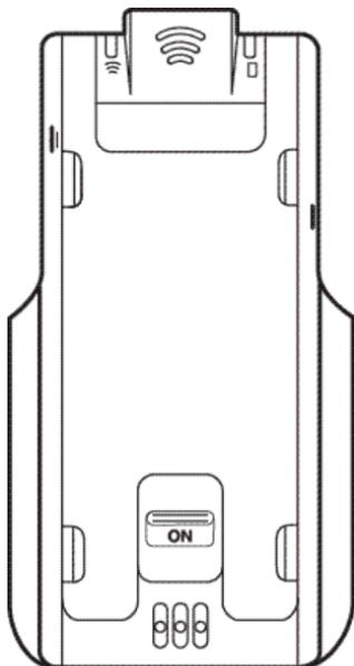
Dispositivo di blocco in posizione ON.
