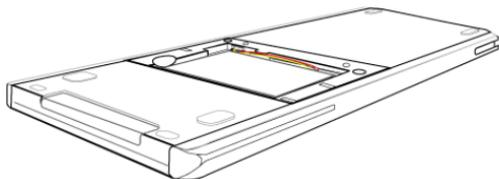
6. Riposizionare il pannello posteriore e fissarlo con un cacciavite.
