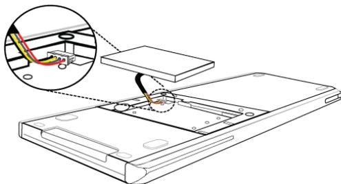
5. Inserire la batteria ricaricabile nel vano.
